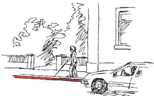
**Bordi bassi:** prevedere un gradino di 3 cm oppure un bordo inclinato ma con un dislivello di 4 cm (cfr. 2.5.2). Evitare ulteriori rialzi provocati da dislivelli del rivestimento.
