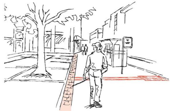
Usare le **canalette drenanti** come elementi di guida. L'avvallamento delle canalette deve avere una profondità pari a 1/15 della loro larghezza, ma almeno di 3 cm (cfr. 2.5.2).
