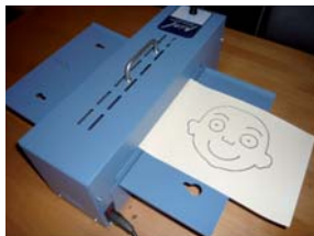
Forno ad infrarossi per disegni in rilievo
